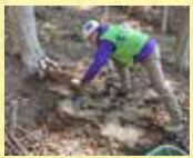
植生実験草貼付け
